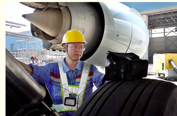
雷跃对起落架进行超声检测。
